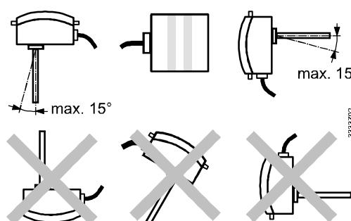
Regulator nie może być montowany trzpieniem czujnika skierowanym ku górze, kabel musi być doprowadzony od dołu.
