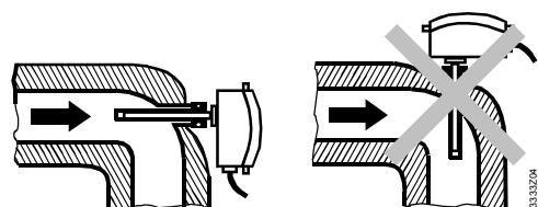
Nach Möglichkeit in einen Rohrbogen einbauen. Der Tauchstab soll gegen die Strömung zeigen.
