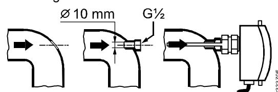
4. De beschermhuls monteren in de draadplug. Bij montage van de beschermhuls hulpmiddelen voor afdichting toepassen (hennep, teflontape, enz.)
