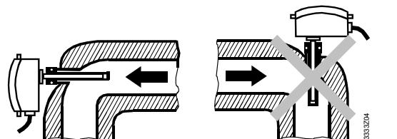
Il regolatore dovrebbe essere montato in una curvatura con il bulbo rivolto controcorrente.
