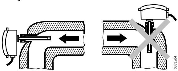
El controlador debe montarse en un codo de la tubería con la vaina de protección enfrentándose a la dirección del flujo.
