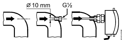
4. Schutzrohr in den Gewindestutzen einbauen. Wenn nötig, Hilfsmittel zum Abdichten verwenden (Hanf, Teflonband usw.)
