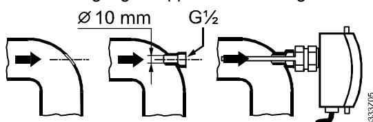
4. Montera dykröret i den gängade nippeln. Om så erfordras använd tätningsmaterial (hampa, teflonband osv.)
