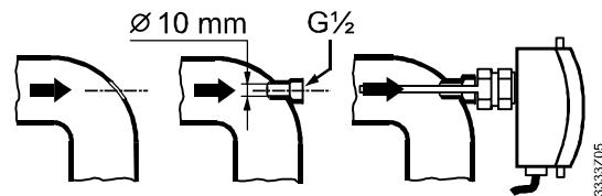
4. Fissare la guaina di protezione e, se necessario, utilizzare materiali per guarnizioni (canapa, teflon o similari).
