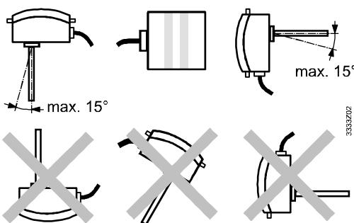
De regelaar mag niet op zijn kop staan; de kabelingang mag niet naar boven zijn gericht.
