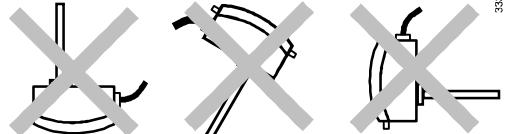
El controlador no debe montarse boca abajo y el cable no debe introducirse desde arriba.
