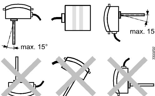
Le régulateur ne doit pas être retourné ; l'entrée de câble de doit pas se trouver en haut.
