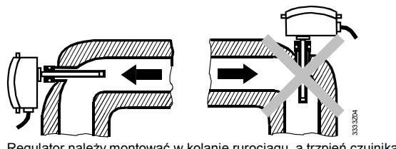
Regulator należy montować w kierunku rurociągu, a trzpień czujnika powinien być skierowany „pod prąd” względem kierunku przepływu
