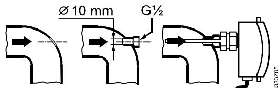
4. Zamontować osłonę ochronną w rurociągu. W razie potrzeby zastosować materiał uszczelniający (konopie, taśmę teflonową lub podobne).
